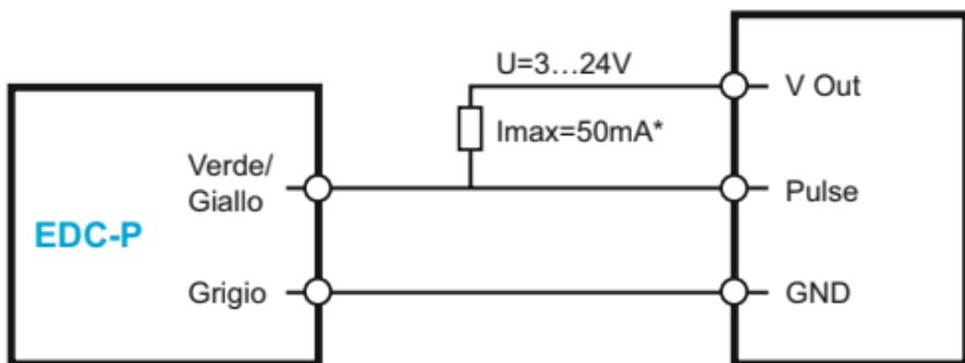
\* Il collegamento di una resistenza esterna si può rendere necessario per garantire una limitazione della corrente.
