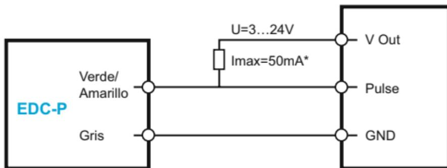
\* La conexión de una resistencia externa puede ser necesaria para asegurar la limitación de la corriente.
