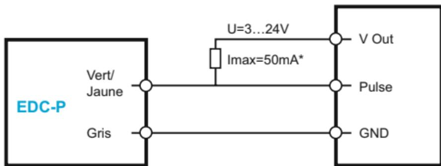
\* La connexion d'une résistance extérieure peut être nécessaire pour assurer la limitation de courant
