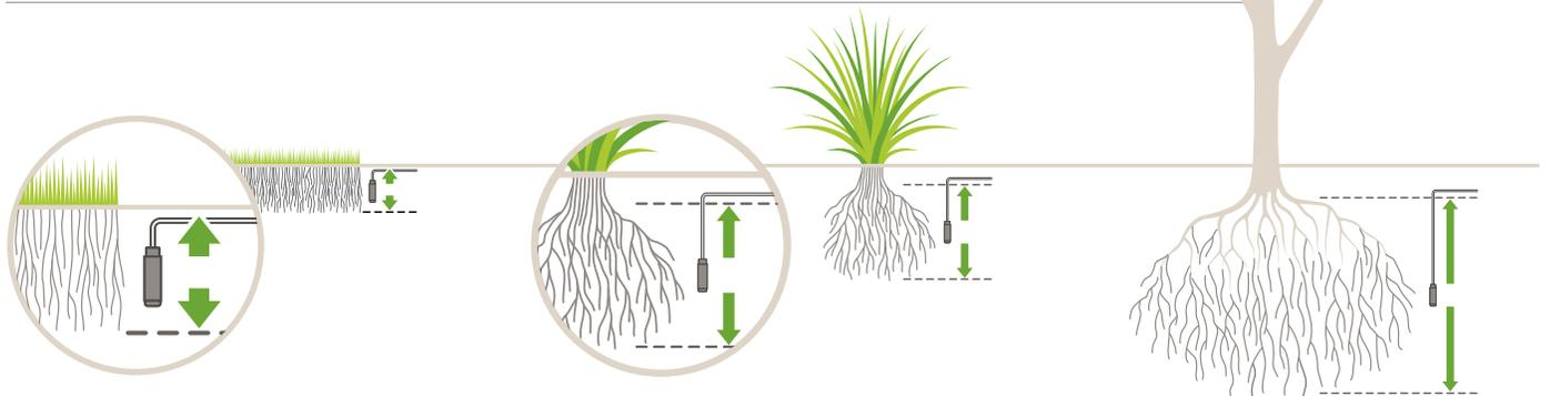
Bei dem Einbau in Rasenflächen soll die Sonde im Bereich der Wurzelzone, in einer Tiefe von ca. 15 cm, eingebaut werden (abgestimmt auf tatsächliche Wurzeltiefe).
