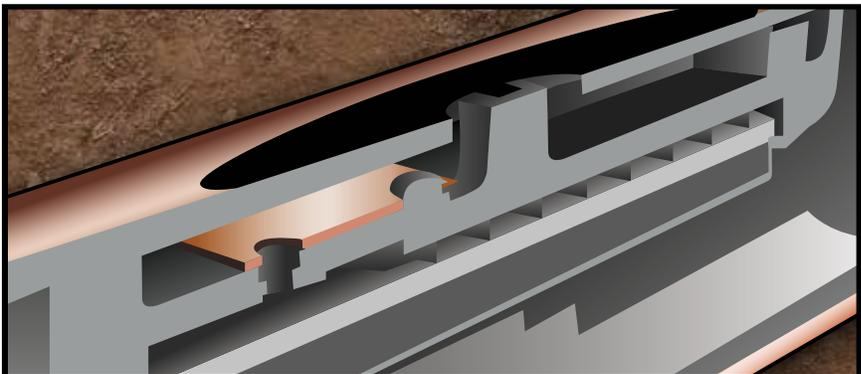
XFS-Tropfer werden vor Wurzeleinwuchs durch die zum Patent angemeldete Rain Bird Copper Shield-Technologie geschützt, sodass im System keine Wartung und kein Austausch von Chemikalien notwendig ist, um Wurzeleinwuchs zu verhindern. Die kupferfarbene Außenseite stellt sicher, dass der Kupferchip innen ist.
